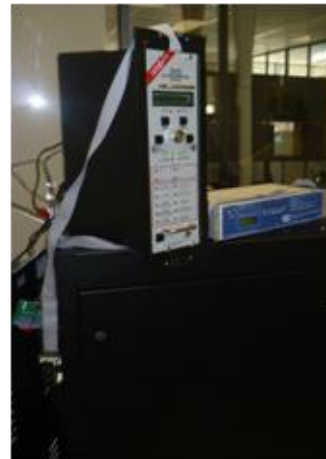
D) Conexión de relevadores comerciales con simulador digital en tiempo real.
